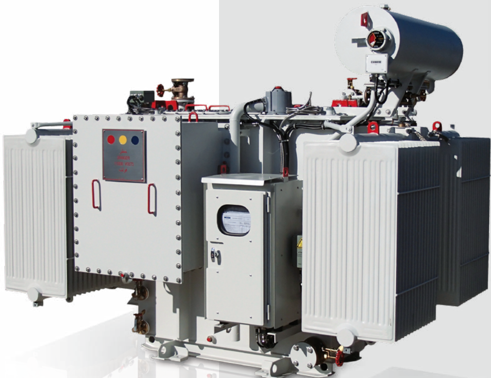
TRANSFORMATOR FÜR EMU Auf Stoss und Vibration geprüft bei ISMES/CESI, Italien Typ: MOZ 1510-27,5, Kroatien Nennleistung: 1510/4x275/160/100/150kVA Nennspannung: 25000/4x800/1000/400/340V
