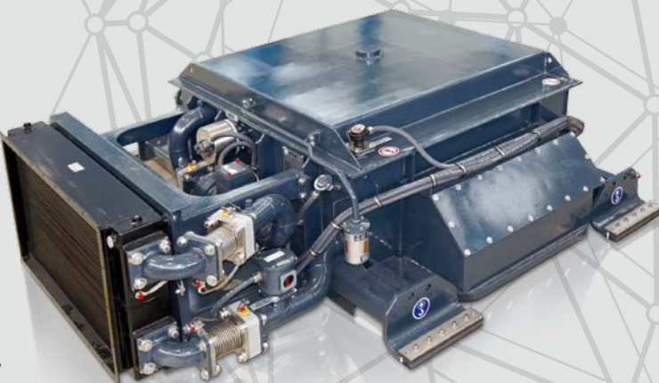
TRANSFORMATOR FÜR EMU Auf Stoss und Vibration geprüft bei ISMES/CESI, Italien Typ: MOZ 1510-27,5, Kroatien Nennleistung: 1510/4x275/160/100/150kVA Nennspannung: 25000/4x800/1000/400/340V
