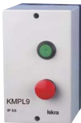
Uporabljajo se predvsem za vklop, preobremenitveno zaščito in izklop elektromotorjev, lahko pa tudi za druga bremena. V ohišju stopnje zaščite IP55 sta vgrajena kontaktor in ustrezeni bimetalni rele, ki ju vklapljamo s tipko za vklop in izklapljammo s tipko za izklop, ki je obenem tipka za izklop v sili in je gobaste oblike.
