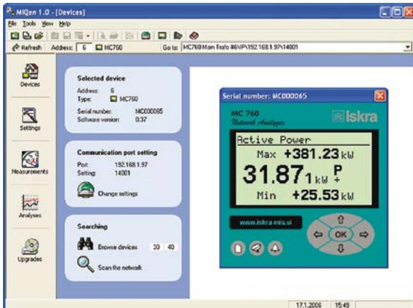
**Programska oprema za analizo meritev instrumentov Iskre MIS**
