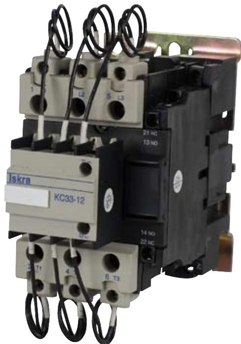
V trenutku vklopa kondenzator lahko učinkuje kot kratkostični element. Velikost kondenzatorjevega tokovnega sunka ali polnilnega toka je odvisna od velikosti izmenične napetosti v trenutku vklopa ter od impedance priključnih kablov in napajalnega transformatorja.
