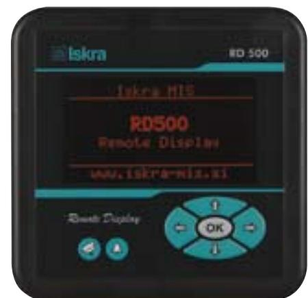
Отображение электрических характеристик и дистанционная настройка измерительных преобразователей MT 5x0 / UMT 5x0
