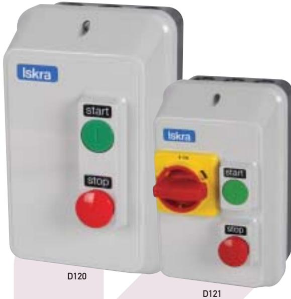
Per esempio, avviatore diretto, potenza del motore 4kW a 380/400V trifase, contattore con bobina a 220/240V, scatola con pulsante start/stop ed interruttore principale integrato: Relè termico di sovraccarico TRB14/KNL16...10, contattore KNL9/M7, scatola D1211.
