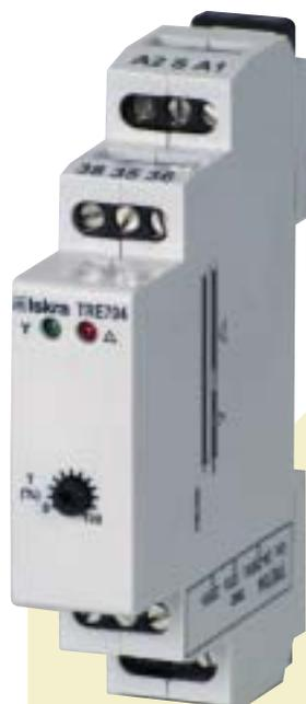
Dopo aver collegato l'alimentazione, il relè Y è attivato per il tempo T1, segue poi un'interruzione della durata T2=100ms, dopodiché si attiva il relè Δ.
