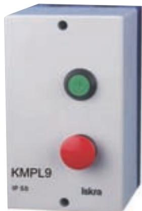
Se utilizan sobre todo para la conexión, la protección de sobrecarga y la desconexión de motores eléctricos, es posible además utilizarlos para otras cargas. En una carcasa con grado de protección IP 55 se encuentran incorporados un contactor y un relé bimetalico correspondiente, los cuales conectamos con una tecla para la conexión y desconectamos con una tecla de desconexión la cual a su vez es una tecla para la desconexión de emergencia, la cual tiene una forma de hongo.
